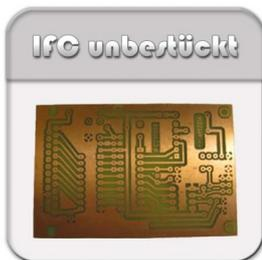
Leiterplatte Interface - Verbindung zwischen PC und der ATC - Modellbahnsteuerung. (ohne UM2102)
